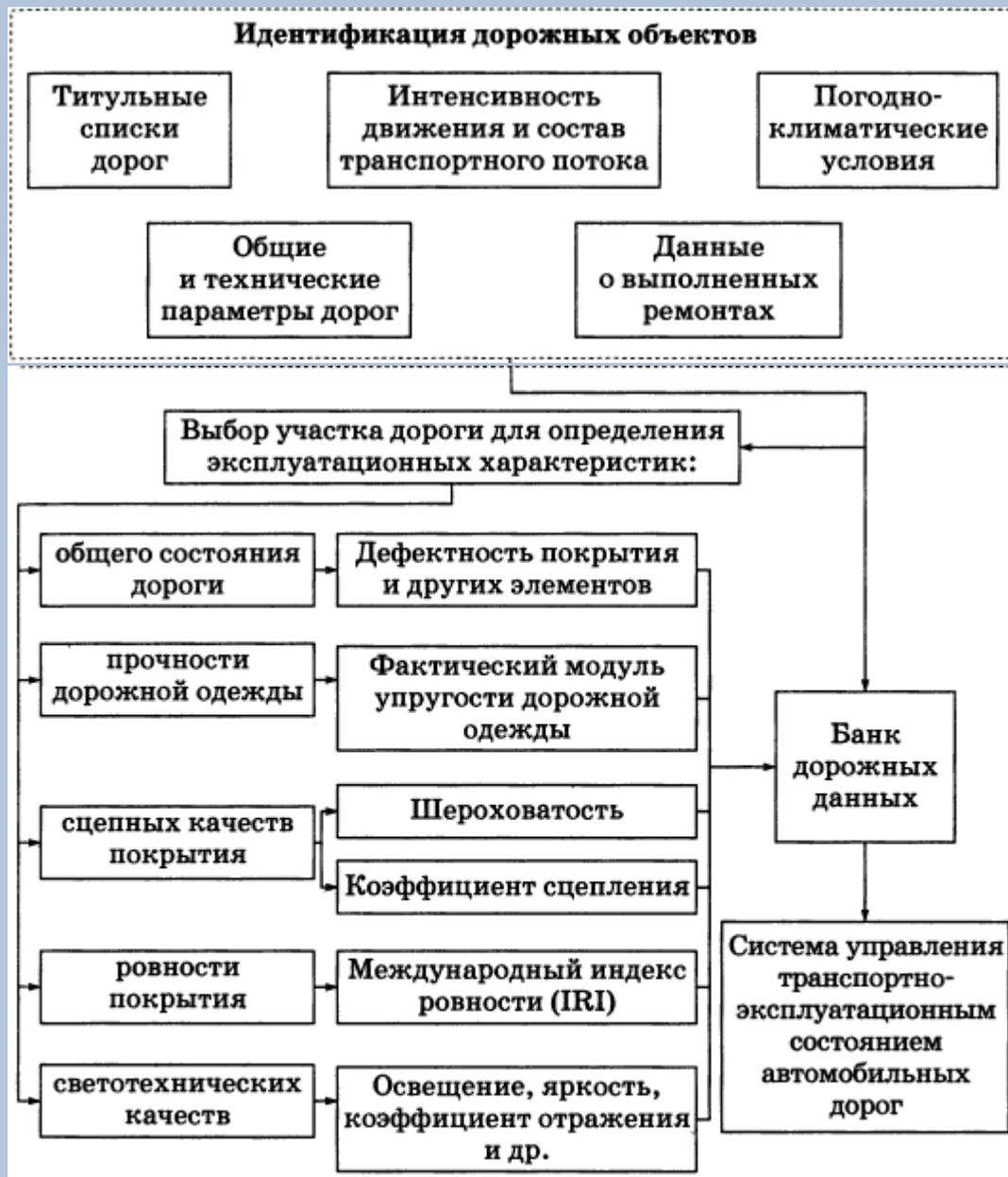
**Рис. 4.3 – Система диагностики автомобильных дорог**
